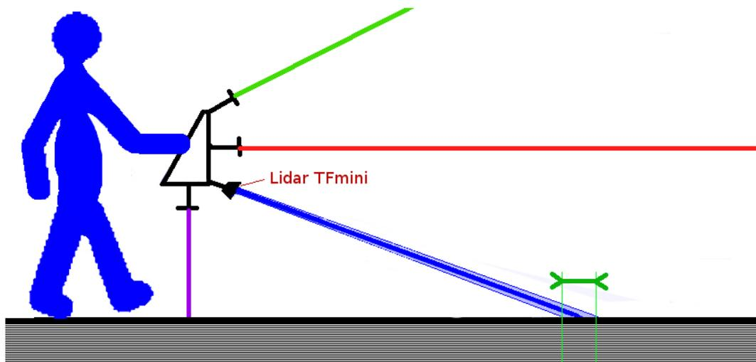
La portée accrue du Lidar (plus de 10m) permet des mesures plus profondes dans le cas de déclivités ou de trous dans le sol.
