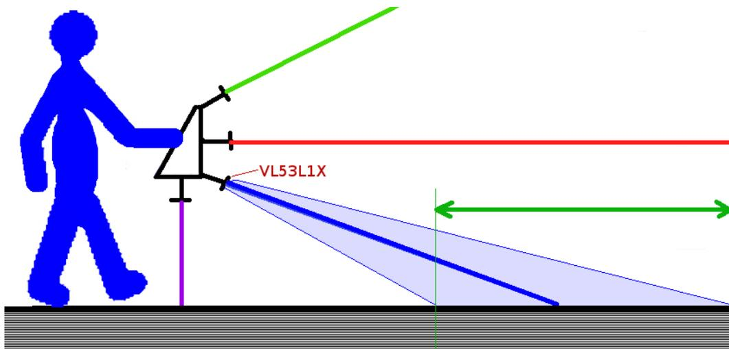
Tout en conservant la même incidence, on remplace ce laser par un Lidar TF mini dont le faisceau a un angle d'ouverture de 2,3°, la zone couverte sur le sol est alors beaucoup plus réduite. La précision des mesures s'en trouve donc accrue et la pertinence des alertes en est améliorée.
