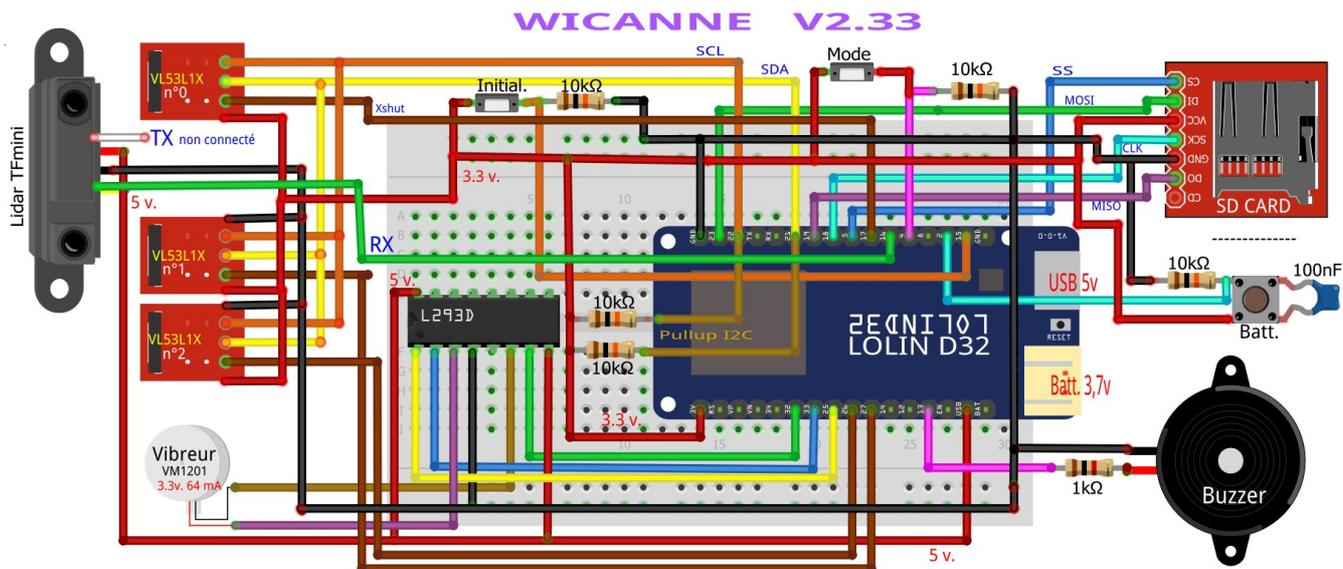
L'appareil dispose d'un port USB pour le chargement du programme et/ou la mise au point sur PC. Il peut fonctionner de façon autonome en branchant sur le port USB une batterie 5v. (ou un power-pack).
