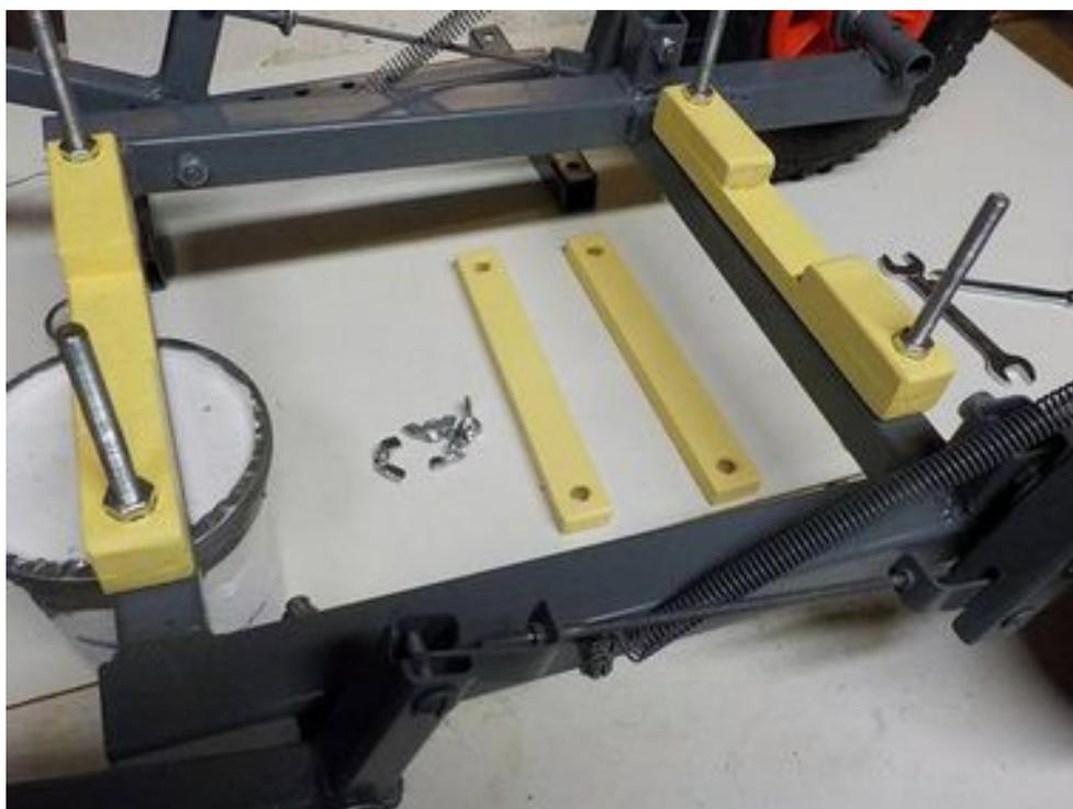
Serrage du tube selle réalisé
