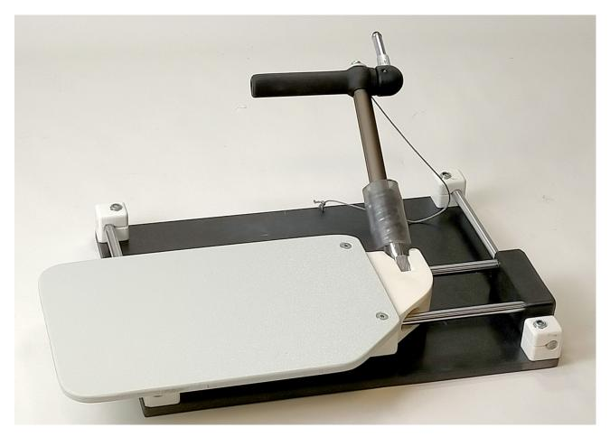
Comme on peut le voir sur la photo du système réalisé ci-dessus, le ressort d'amortissement du bras est gainé d'une protection faite d'un tube en silicone.
