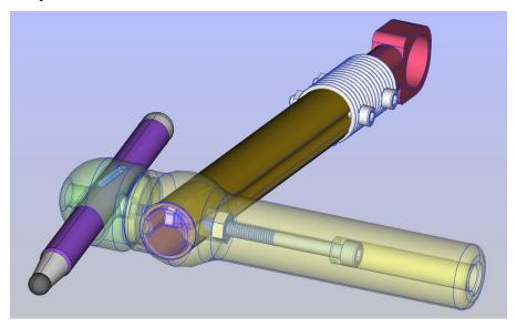
Le bras est muni à l'une de ses extrémités d'une pièce de liaison (rouge) qui est enfilée sur l'un des roulements linéaires du chariot X afin de permettre son oscillation dans le plan vertical.
