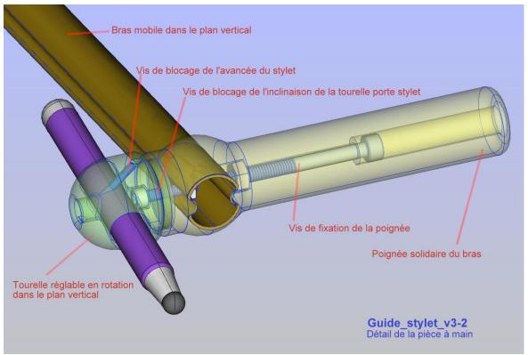
NB : n'est pas représenté sur la vue ci-dessus le bouchon venant obstruer l'extrémité du bras et maintenir en place l'écrou de serrage de la tourelle.
