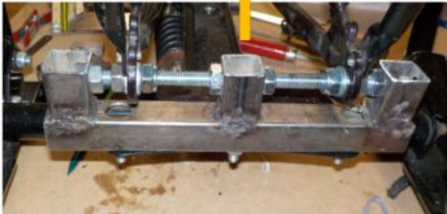
La fixation arrière est réalisée en tubes carrés soudés
