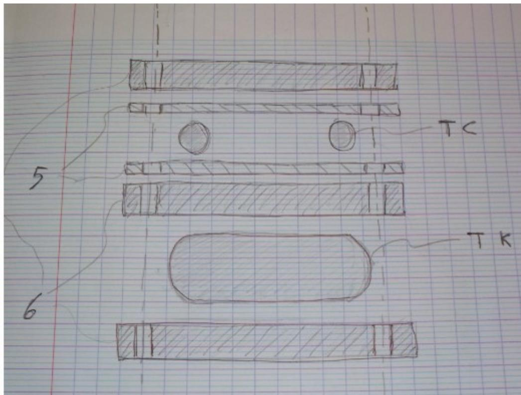
Assemblage de l'ensemble par deux tiges filetées M8 x + quatre écrous frein M8
