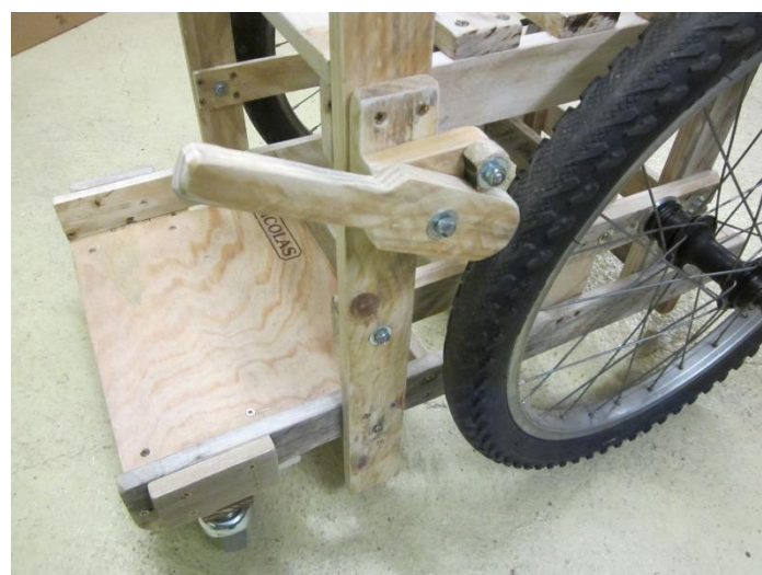
Frein serré et rondelle-butée meulée.
